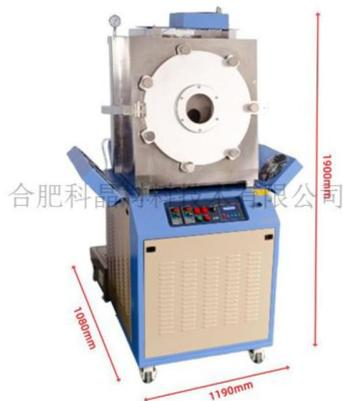
YLJ-VHP7 是一款真空平板热压机，专为晶圆键合、薄膜转移和 LCP 层压设计，加热面积为 135 ×135mm~350×350mm。其最高工作温度为 750 °C，最大压力为 20T~40T。
