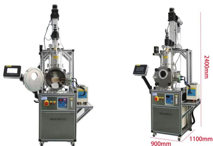
IMCS-2000-CZ 是一款小型的提拉法 (CZ) 晶体生长炉, 生长单晶直径 < 25mm。此设备最高温度可达 2100℃, 可用于生长 Al<sub>2</sub>O<sub>3</sub>, GGG, YAG, LaAlO<sub>3</sub>, Si, Ge 和各种金属单晶等。
