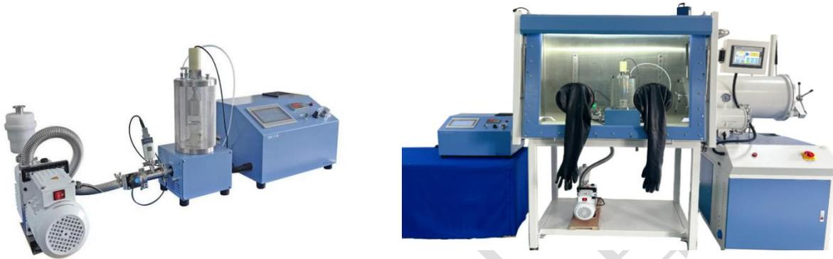
GSL-1700X-SPC-2 是一款小型台式分体式程序控温蒸发镀膜仪，可以触摸屏设定程序，精确控制温度 200℃~1500℃，可制备各种金属薄膜和有机物薄膜。分体式设计，可放入手套箱中使用。
