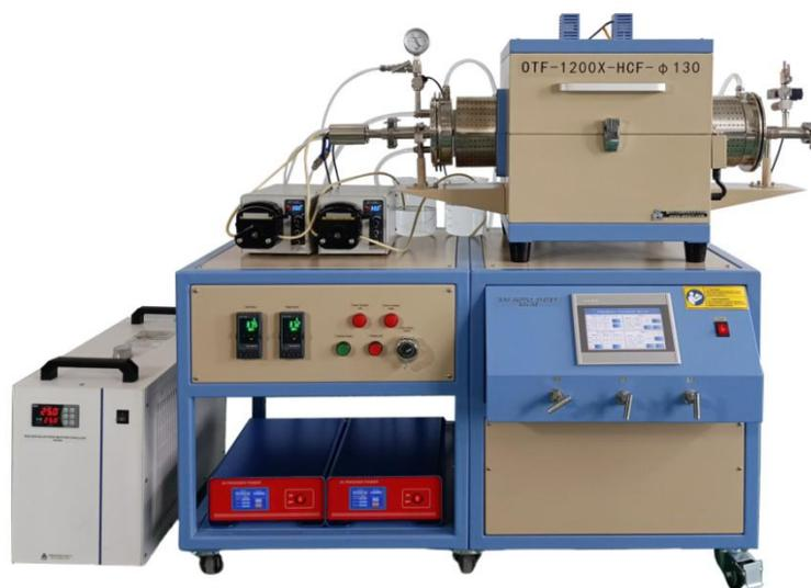
OTF-1200X-HCF-φ130 是一款由双温区管式炉、供气系统、蠕动泵和超声雾化仪组成的系统，整套系统的电路控制通过供气系统的触摸屏控制实现，在触摸屏上面设置加温程序、雾化载气流量、进气流量等参数，系统将自动按照设定程序进行运行，最高温度可达 1200℃。炉管两端安装有防爆网，以便在出现紧急情况下提供额外的安全保护。控温系统采用 PID30 段程序化控温，控温精度可达±0.1℃。
