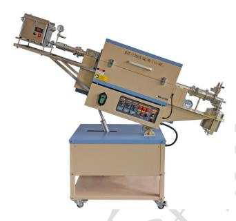
OTF-1200X-5L-III-AF 是一款三温区管式炉,带有自动进料、传输和反应的装置。自动进料器可控制粉体进入到管式炉炉管内的速率。螺杆传输器将粉料运送穿过管式炉加热区(控制螺杆转动速度来决定粉末在加热区内的停留时间),通入各种 CVD 反应气体,可用此设备连续对粉末进行复合合表面包裹。此款设备可用于探索新一代壳核材料或 CNT 复合材料。(图片仅供参考,请以实物为准)
