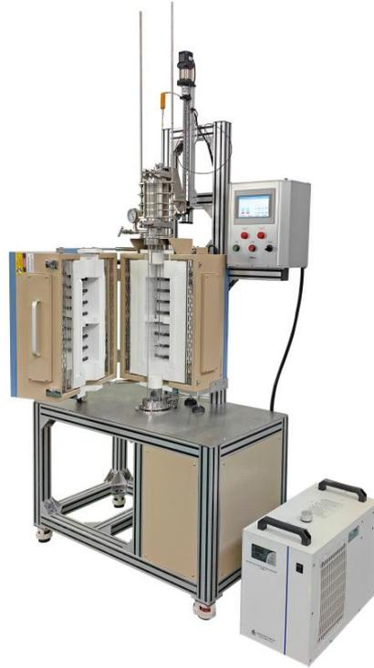
OTF-1500X-II-VT 是一款带升降机构的立式双温区管式炉。设备主要由滑台模组和炉体组成，炉体采用立式双温区管式炉，最高温度为 1500℃，炉管为直径为  $\phi 80\text{mm}$  的石英管。滑台模组具有提拉功能可用于生长各种晶体材料，并且配有不锈钢密封法兰。带有 50 段可编程的精密数字温度控制器内置在炉内，具有  $\pm 1^\circ\text{C}$  的控温精度。
