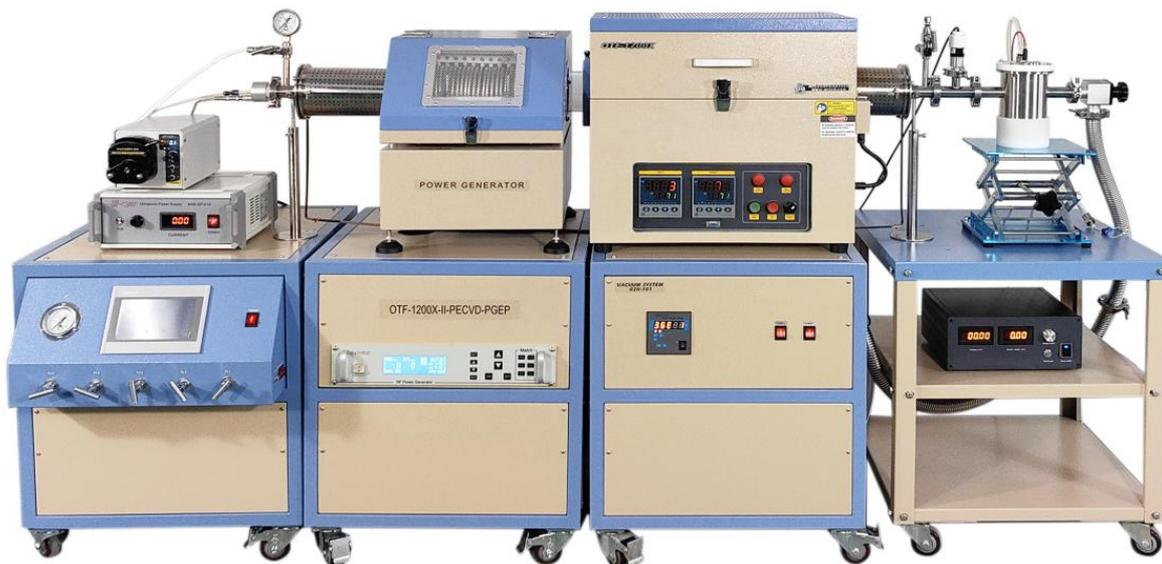
OTF-1200X-II-PECVD-PGEP 是一款多功能的合成系统，组成部分为 500W 的射频电源、双温区管式炉、供气系统、真空系统和高压静电收集装置。材料制作分为三个步骤：前驱体雾化，加热和纳米颗粒收集。双温区管式炉以电阻丝为加热元件，采用双层壳体结构和 50 段程序控温，K 型热电偶，炉膛采用高纯氧化铝纤维材料，此款设备可用于生长纳米线或用 CVD 方法来制备各种薄膜。
