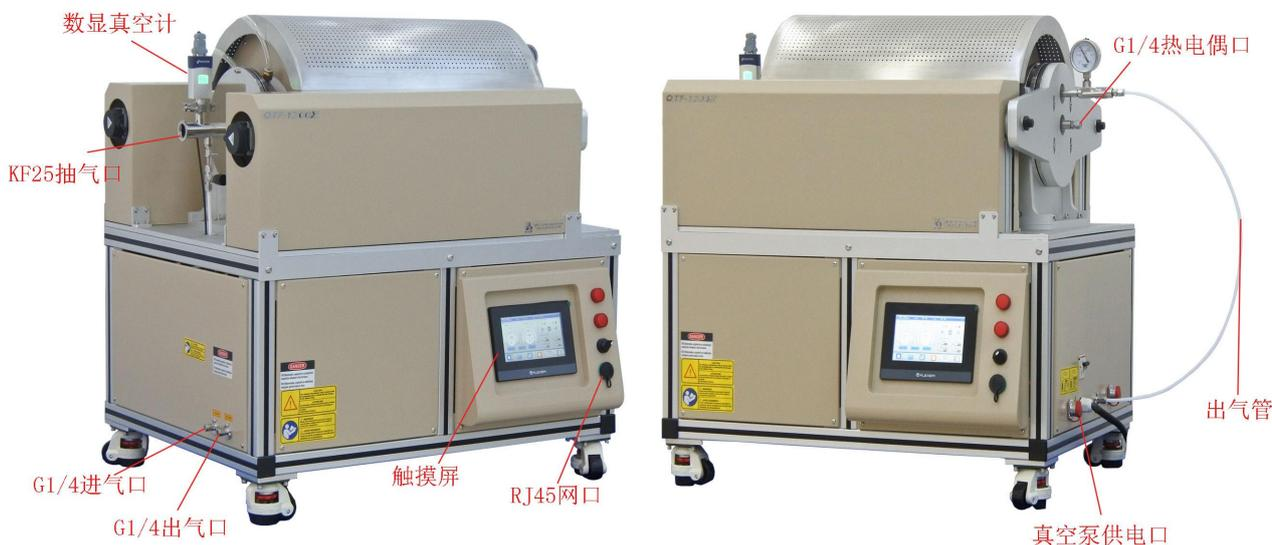
GSL-1200XS1-ASD 是一个炉管外径 30mm 全自动加热管式炉，通过 PC 上位机软件预设工艺流程可实现一键式操作自动执行烧结工艺，可配合协助机器人完成自动放样，自动关闭及密封法兰，自动通入预设的真空度和洗气流量进行气体置换、自动运行预设气体流量通入、炉体升温、恒温、降温、并自动打开法兰取出样品，可以进行多次循环操作。可实现一台 PC 机控制多台设备工作，并配合协助机器人可以实现全天候不间断全自动高通量样品烧结，配置的控制软件可实现远程/近程控制设备的真空、供气、烧结、开关炉门等一系列操作，该设备最高温度可达 1200℃。
