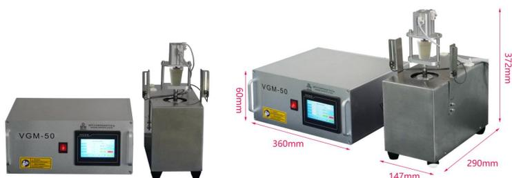
MSK-VGM-50 是一款自动化小型立式研磨机，可对烧结后的陶瓷材料进行破碎，和球磨细化，出料粒径可达 0.1 $\mu$ m，与外部机械手配合可实现完全无人化操作，采用 DC220V 电机驱动，可在 Ar 环境下的手套箱内使用。可适配各种研磨罐：10ml 至 50ml,冲击振幅 16mm,最高转速可达 1500rpm。
