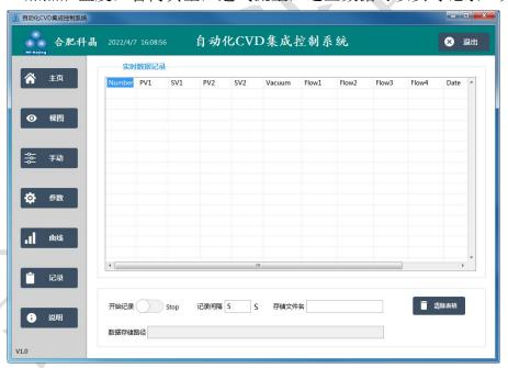
4. 软件有工艺曲线自动生成功能,把加热炉温度,真空度,进气流量等参数进行存储生成工艺流程,最大可以存储 100 条工艺流程,也可以调出工艺流程一键自动运行设备。
