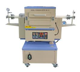
GSL-1500X-OTF-R-II 是一款双温区回转管式炉,最高温度可达 1500℃,此设备的特点是在样品进行烧结过程中炉管可以转动,可使所烧结的粉体样品烧结效果更佳均匀。
