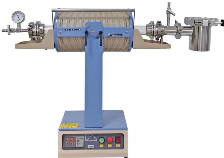
GSL-1100X-S-VTQ 是一款小型立式淬火炉，标配有  $\phi 50\text{mm}$  石英管、真空密封法兰以及样品淬火密封罐。实验时，材料可放置于石英管中，在真空或惰性气氛保护下加热到所需温度，之后手动倾斜炉体，最大倾斜角度可达  $60^\circ$ ，可方便实现淬火工艺，非常适合研究材料相变和微结构性能。
