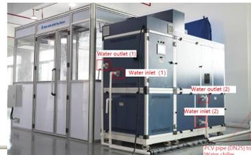
MSK-ADR-1500EP40 是一款小型的步入式干燥房，面积为 9m<sup>2</sup>，露点 < -40℃ 将新型的两级除湿技术应用在此干燥房上，与传统的除湿技术相比，设备噪音更低和更节省电力。
