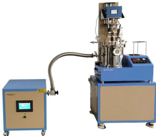
RTP-M1 是一款小型的可视化快速高真空热压炉，压力可自动调节，样品可视化。有手动和自动两种加热方式，最高温度可达 2600℃，加热速率可达 200℃/s。配备有三种法兰上盖（标准、加压、可视化），它是一款在快速加热和快速降温条件下研究材料性能的设备。
