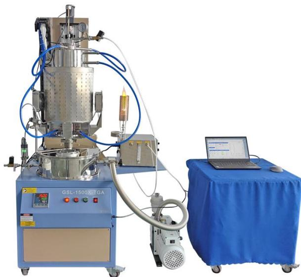
热重分析法 (TG, TGA) 是在升温, 恒温或降温过程中, 观察样品的质量随温度或时间的变化。GSL-1500X-TGA 是一种紧凑型管式炉, 适用于中小尺寸样品的热重分析仪器, 具有精确的热重量分析法功能, 最高可达 150g, 为工业提供更准确的结果, 并且可以在真空和可控气体气氛下运行, 以研究材料加工过程中的相变。TGA 炉还可以连接气体分析装置, 以研究加热过程带气体成分的变化和重量的变化。
