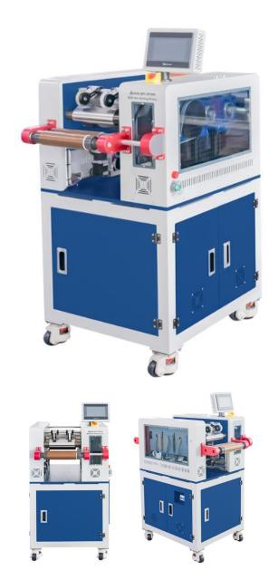
MSK-BPC-DF200 是一款 3 辊连续辊轧机, 3 个辊的转速可独立设置, 用于锂电池电极制备, 基底也用各种金属箔材, 如铜, 不锈钢, 镍合金等。3 个轧辊的转速可独立调控, 最大压力可达 8T。
