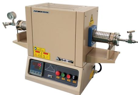
GSL-1400X-S 是一款小型管式炉，可设置 30 段升降温程序，并带有断偶和过热保护功能，控温精度高达  $\pm 1^{\circ}\text{C}$ ，仪器最高温度可达  $1500^{\circ}\text{C}$ 。此高温管式炉特别适合于在气氛保护或真空环境下对样品进行退火和烧结。
