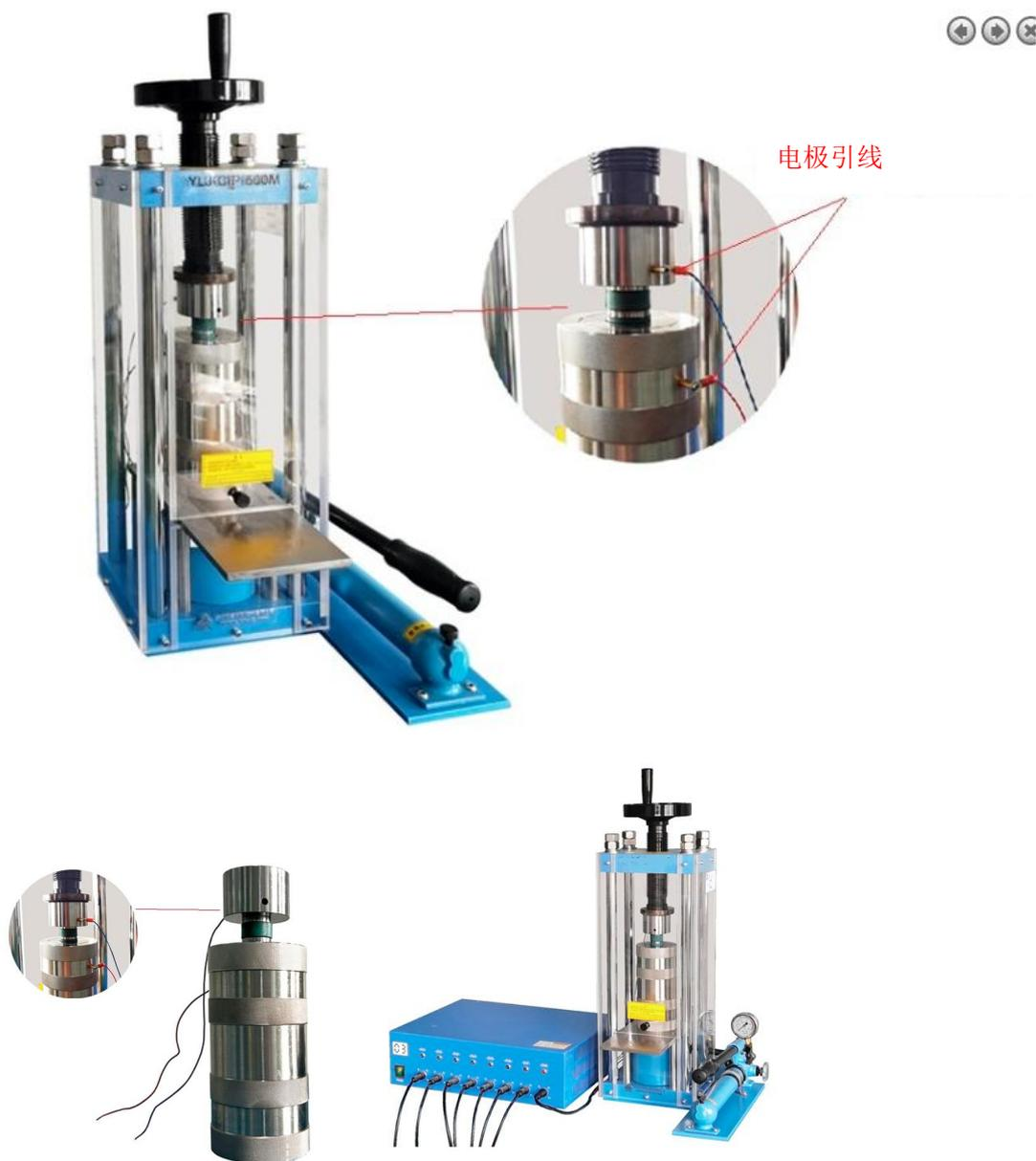
YLJ-CWIP-300 是一款手动等静压机, 等静压模具上电极引线柱可原位测试被压样品的电性能, 模具内径 30mm, 最大压强可达 300MPa。此套 CIP 或 WIP (可选) 配有一个 24T 的手动油压机。此款产品特别适合研究压力和温度对固体电池容量和寿命的影响。
