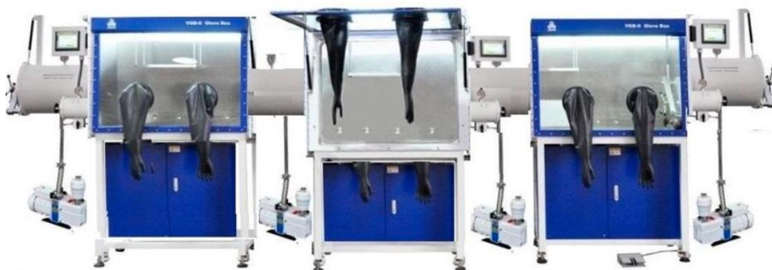
VGB-6-III-2T 是一款三腔体循环净化手套箱系统，带有 2 个转移仓用于腔体之间样品转移，安装有独立的仓门。3 个独立的净化系统分别对 3 个腔体除水和氧达到 1PPM 以下。
