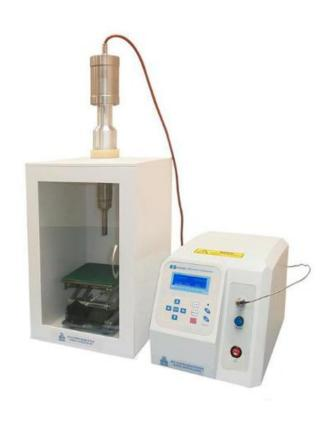
MSK-USP-3N 是一款桌面式 300W 超声处理器,配有一个隔音腔和不锈钢升降台。此款设置主要用于分散液体中的纳米粉体,使液相中的共沉积状态到均质化,也可将多种化学物质进行高质量混合。此款超声处理器特别适合于用溶胶凝胶发制备新一代 LED 荧光粉,锂电池浆料等。
