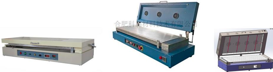
MSK-AFA-L1000 是一款 350mm 宽，长度 1000mm 的平板流延涂布机，带有底部加热真空板，最高温度 120℃ 和一个微米级别的可调式刮刀。此款涂布机专用于制备长度较大的厚膜，可在各种基底上涂布制备平面均匀的膜。特别适合涂布各种电池材料，用于柱状电池（如 21700 柱状电池）。
