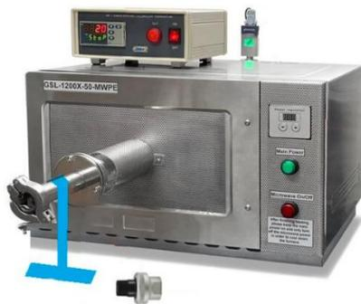
GSL-1100R-MWPE 是一款 MPCVD（微波辅助 CVD）回转炉。安装有一个 2.45GHz 的微波发生器，配有一个直径 Φ50mm 的转动炉管（0~5rpm），不锈钢真空密封法兰，设备加热模块的加热温度可达 1100℃。此款设备可快速对粉体进行热处理，表面改性和在粉体材料表面包覆另一种材料。
