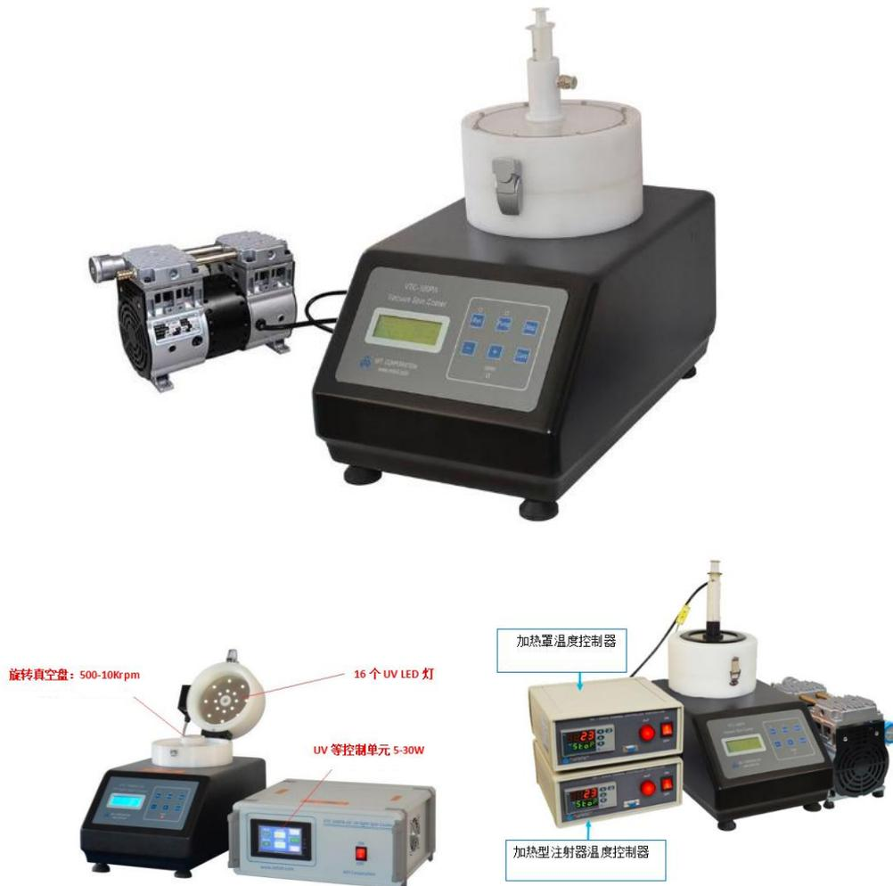
VTC-100PA 是一款桌面型旋转涂布机,最大样品  $\Phi$ 130mm,最高转速 10000rpm,配有 PP 罩。旋转盘采用精密直流伺服电机驱动,可准确控制转速和加速度。样品基片是通过真空吸附固定在旋转盘上。操作界面可程序化编写各种参数,最大写入 12 条程序,6 段程序段,旋转时间,旋转速度,和加速度。设备所有器件都具有抗腐蚀性。
