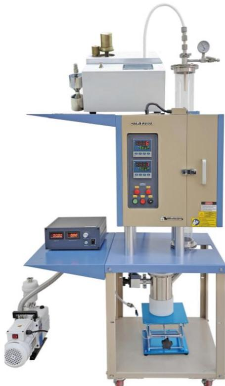
OTF-1200X-II-VT-PGEP 是一款多功能的合成系统，针对于合成各种纳米结构氧化物以及纳米材料的复合包覆工艺，此款仪器有三个组成模块，干粉气溶胶发生器，1200 度管式炉和高压静电收集装置。材料制作分为三个步骤：前驱粉体气溶胶化，加热和纳米颗粒收集。此款系统是一款非常先进的合成系统，可广泛用于纳米材料制备，电极材料包覆复合等方面。（图片仅供参考，请以实物为准）
