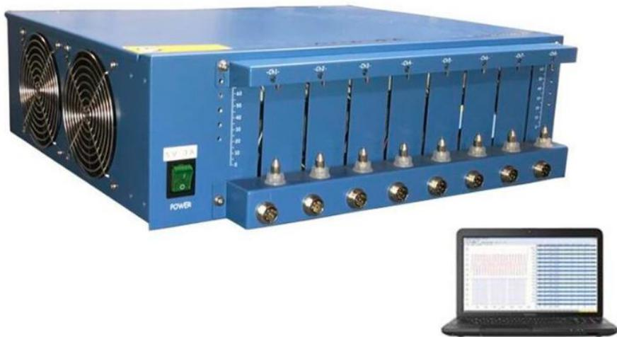
BST8-12A 是一款 8 通道电池测试仪，用于测试分析柱状电池和软包电池，电流范围 6mA-12A。每一个通道都有独立的恒压恒流源，可通过电脑编程软件控制。此款设备广泛应用于电极材料研究，电池性能测试等。
