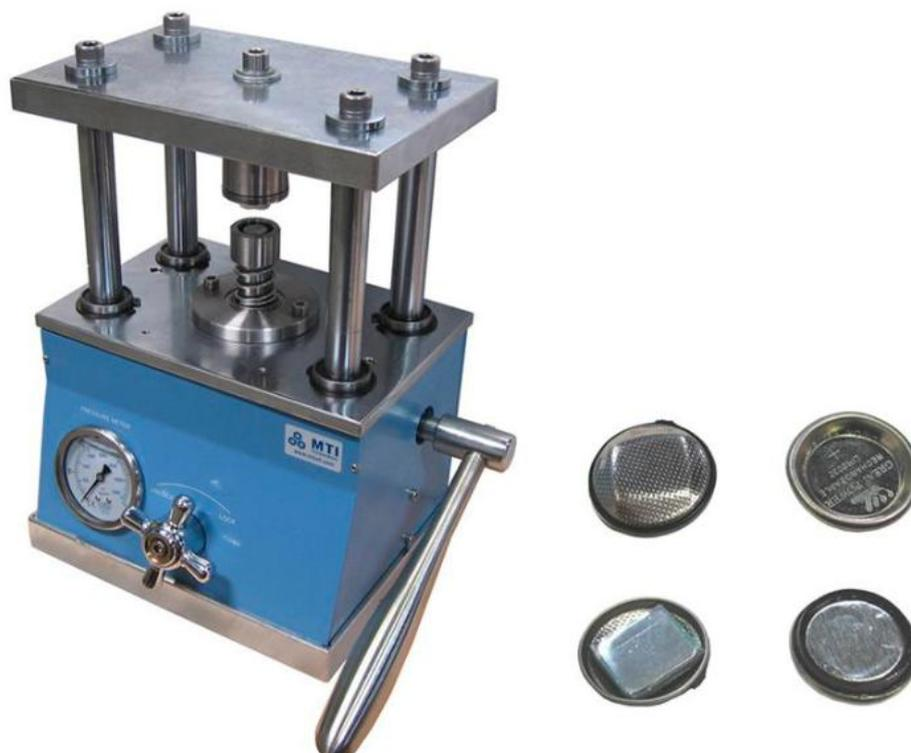
MSK-110D 是一款手动液压扣式电池拆卸机，可用于拆卸各种扣式电池，如 CR2032, CR2025 和 CR2016，而且拆卸电池后不毁坏电池内部的极片，可用于研究电极材料。可定制模具用以拆解 CR2325，CR2450 和其他型号的扣式电池。MSK-110D 设计是在手套箱外使用，不建议在手套箱内使用。
