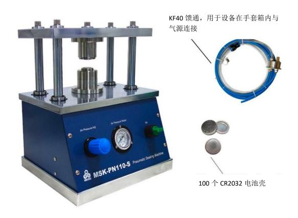
MSK-PN110-S 是一款小型的扣式电池封装机,通过气缸封装各种扣式电池 CR2016,CR2025和CR2032。此款设备可提供精确的压力控制,快速封装电池,保证封装的重复性。此款设备可在干燥房和Ar环境下的手套箱内使用。这款气动的封装机采用气缸驱动,设备无油,不会污染手套箱和干房的环境。
