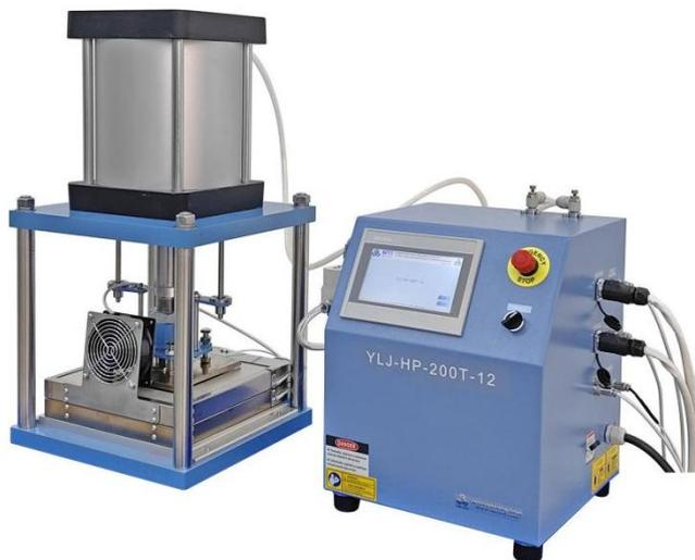
YLJ-HP-200T-12 是一款气动热压机，带有精密恒压控制器，压力精度控制在 $\pm 1\text{kg}$  以内，压力可达 1.6T，温度可达 200 °C。它是专为测试压力对固态电池性能的影响而设计的，也可用于热压下固态电池电极的 SEI 形成和层压。该装置具有氩气兼容性，可用于手套箱。
