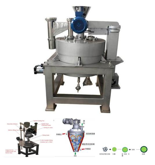
JVC-15 最初设计是用于电池阳极粉末材料表面包覆碳,将电池粉体材料和沥青在高温环境先搅拌混合,实现在粉体材料表面包覆碳(如 Si,或 SiOx 表面包覆碳),可改善电池的循环寿命。
