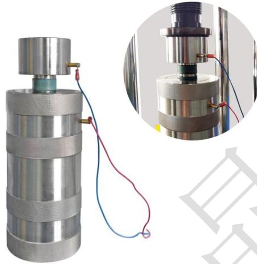
此款模具通过装置上的电极引出电极线，可以实现在高压下（300Mpa），对样品进行电化学性能测量。
