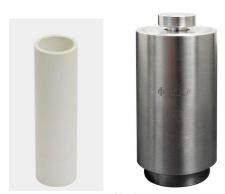
BNL-12D 是一款内径 10.75mm 的干压模具,带有 BN 或 PEEK 内衬(起绝缘作用),可在对样品加压过程种测试材料电性能。同时也可用于对陶瓷,聚合物,陶瓷-聚合物复合材料进行冷烧结(CSP),用于如微波介电材料,固态电解质和半导体等。
