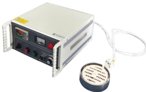
此装置是一款  $\phi 100\text{mm}$  的陶瓷加热平台，适合用于手套箱和高真空环境中。它被广泛用作 DIY 溅射或蒸发镀膜机的可加热样品架，最高温度可达  $600^{\circ}\text{C}$ 。
