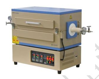
OTF-1500X-III 是一款三温区开启式管式炉,三个温区分别由三个独立的温控系统控制。可以设置 30 段升温程序,并带有断偶和过热保护功能,控温精度高达±1℃,仪器最高温度可达到 1500℃。此高温管式炉特别适合于在气氛保护或真空环境下对样品进行退火和烧结。
