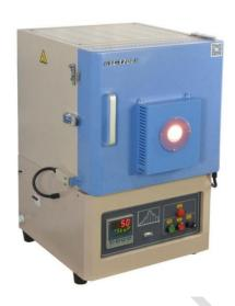
KSL-1700X-A1-W 高温箱式炉是一款 CE 认证的可视台式高温箱式炉。炉膛采用高纯氧化铝纤维绝缘材料和 1700 级硅钼棒加热元件组成,高精度 SCR 和温度控制器配套使用测量和调节温度,控温精度±1℃,最高温度可达 1700℃。带有石英观察窗口,可在工作过程中随时观察物料状态,是专门为高等院校、科研院所的实验室及工矿企业对金属、非金属及化和材料进行烧结、融化、分析而研制的专用设备。
