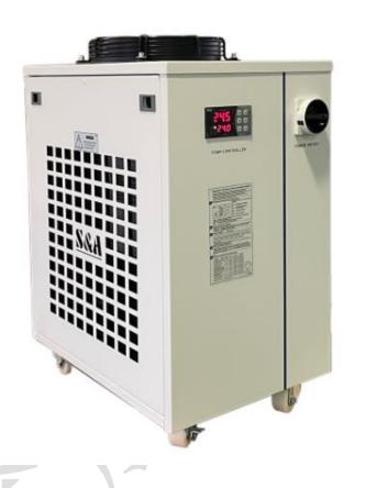
CW-5300 是通过 CE 认证的专业水冷设备,水箱容量为 10L,水流速率可达 16L/min,可以很好的冷却加热设备,具备恒温与智能调温两种工作模式,是一款使用方便又经济的水冷设备。
