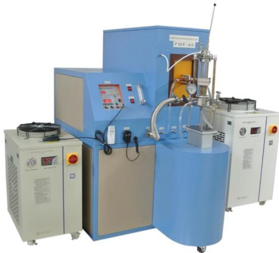
FMF-300 是一款真空感应加热炉，专门针对于新型磁性合金材料和金属材料的探索。此系统是应用 60KW 的高频感应电流进行加热，特殊的带水冷铜坩埚设计能够使样品在加热过程中瞬间悬浮起来。所以可以保证反应物的纯净度。
