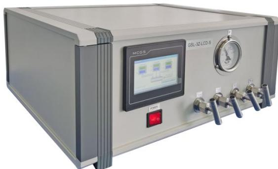
GSL-3Z-LCD-S 是一款小型的三通道质子流量计混合系统。PLC 触摸屏控制各通道气路流量，并可实时查看流量数据及曲线。可与本公司各种管式炉 CVD/PECVD、镀膜仪等设备配套使用，实现 PVD、CVD、PECVD 以及热处理等实验气氛的精准控制。
