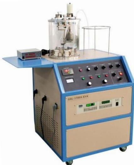
程序控温型四坩埚蒸发镀膜仪 GSL-1700X-EV4 是一款小型温控型蒸发镀膜仪，内部设有四个蒸发坩埚，且每个蒸发坩埚都带有挡板，最多可放置四种不同的蒸发物料，可在同一气氛下依次镀膜，实现多层膜的沉积工艺，可程序控温，控温范围 200-1500 度，样品台可旋转以获得更均匀的薄膜，可制备各种金属薄膜和有机物薄膜。
