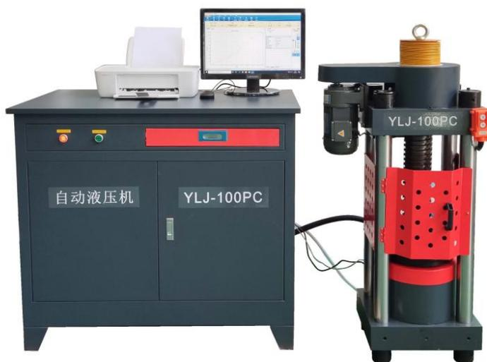
YLJ-100PC 是一款电脑控制的电动油压机，最大压力可达 100T。可用于制备各种混合样品或检测陶瓷样品的强度。可程序控制加压速率，分段压力和保压时间（可设置多段程序）
