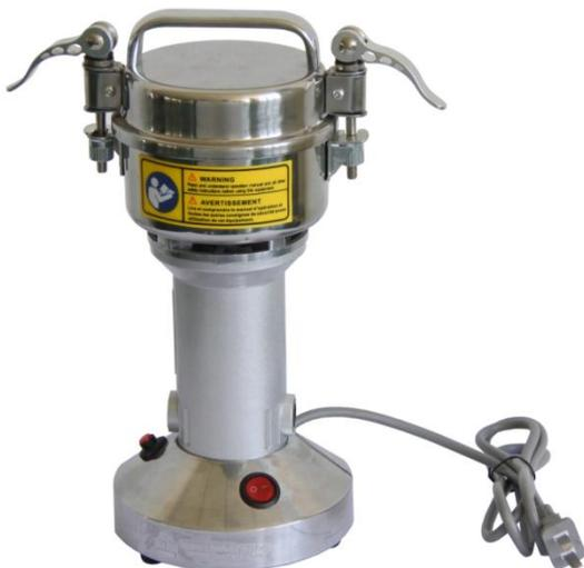
MSK-FS-100 微型旋片式破碎机可用于样品的快速粉碎，三层旋片式破碎，转速高达 22000rpm，对于煤炭、矿石、岩石以及陶瓷化合物来说，是一款理想的研磨设备。
