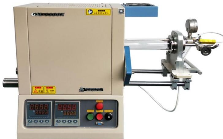
GSL-1100X-RTP50 是一款 CE 认证的可滑动的快速热处理炉, 标配高纯石英管(单端封口), 最高工作温度可达 1100℃。右侧法兰安装有滑轨, 也可以轻松的将炉管移入移出, 从而实现快速加热或冷却。为取得最快加热, 可以预先加热炉子到设定的温度, 然后将炉管插入到加热区内进行加热, 同时也可以样品加热后将炉管从加热炉中移出, 使其在空气中强冷, 从而获得最快冷却。此款炉子是低成本快速热处理的理想设备。
