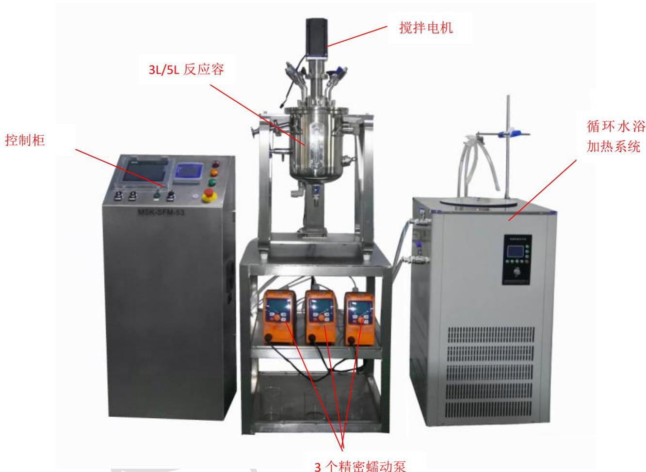
MSK-SFM-53 是一款三元液相反应系统，可选择 3L 或 5L 的反应釜罐体，可自动控温和 PH 值控制，可连续进行液相共沉淀反应来制备前驱体。此款设备特别适合通过液相法制备成分均匀的电池材料粉体和一些成分复杂的化合物。
