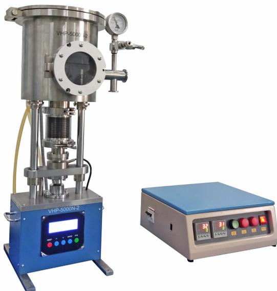
VHP-5000N-2 是一款小型化的平板式真空热压机，针对于晶片的焊接或薄膜转移，其可处理最大样品尺寸为 50mm x 50mm x 15mm。设备优越的性能非常适合于第三代半导体器件的烧结键合研究，仪器最高工作温度为 500℃，最大压力为 5000N。完全满足于半导体器件制备过程中的封装互联材料的封装互联工艺所需，可提供的真空与气氛环境可以尽可能的减少材料的氧化，是极具性价比的实验室研发设备。
