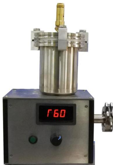
小型密封送料器内外腔体采用 304 不锈钢材料制作，可以在抽真空和高压情况下，对固体颗粒或固体粉末进行自动送料。真空度 $\leq 5 \times 10^{-2}$ torr，最高耐压 0.3Mpa。
