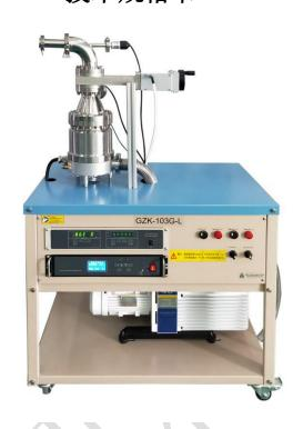
GZK-103G-L 是一款大抽速的国产分子泵真空系统,通过符合真空计和分子泵控制器显示真空度及各项工作状态,操作简单方便。它主要由真空室,阀门及真空连接管道,FF-160/700 分子泵,VRD-48 机械泵,真空测量系统,电器控制系统组成。通过标准配件连接,全部采用不锈钢材料
