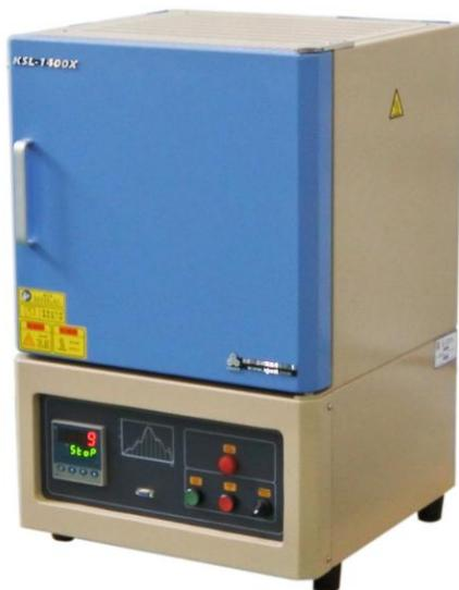
KSL-1400X-A2 是一款高温箱式炉，以硅碳棒为加热元件，采用双层壳体结构和 PID 程序控温，S 型热电偶，炉膛采用高纯氧化铝纤维材料，最高温度能达到 1400 度，可连续工作温度 1300 度，控温精度  $\pm 1$  度，该炉具有温场均匀、表面温度低，节能等优点，是高校、科研院所、工矿企业做高温烧结，金属退火、质量检测用的理想产品。
