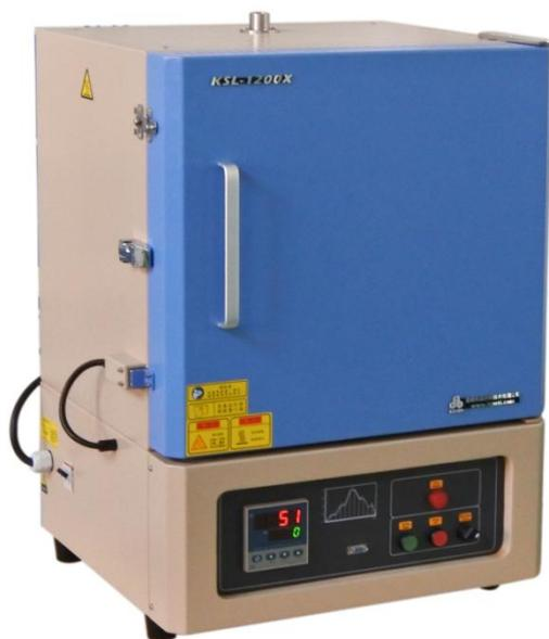
KSL-1200X-M 箱式炉以电阻丝为加热元件，采用双层壳体结构和 30 段程序控温，K 型热电偶，炉膛采用高纯氧化铝纤维材料，最高温度能达到 1200 度，可连续工作温度 1100 度，控温精度  $\pm 1$  度，该炉具有温场均匀、表面温度低，升降温度速度快、节能等优点，是高校、科研院所、工矿企业做高温烧结，金属退火、质量检测用的理想产品。
