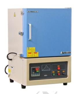
KSL-1700X-A2 是一款高温箱式炉,以硅钼棒为加热元件,采用双层壳体结构和 PID 程序控温,B 型热电偶,炉膛采用高纯氧化铝纤维材料,最高温度能达到 1700 度,可连续工作温度 1600 度,控温精度±1 度,该炉具有温场均匀、表面温度低,节能等优点,是高校、科研院所、工矿企业做高温烧结,金属退火、质量检测用的理想产品。
