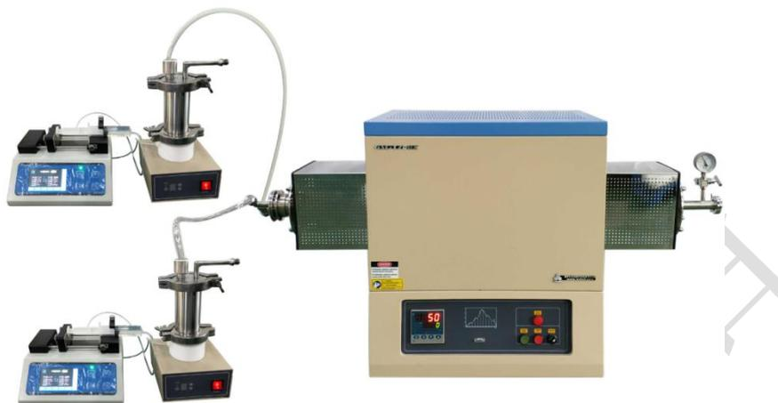
GSL-1600X-80-MIST2 是一款双通道的多功能的碳纳米管合成系统，针对于合成各种纳米结构氧化物以及纳米材料的复合包覆工艺，此款仪器有三个组成模块，超声雾化装置，1700 度管式炉和收集装置。材料制作分为三个步骤：前驱体雾化，加热和碳纳米管收集。此款系统是一款非常先进的合成系统，可广泛用于纳米材料制备，电极材料包覆复合等方面。
