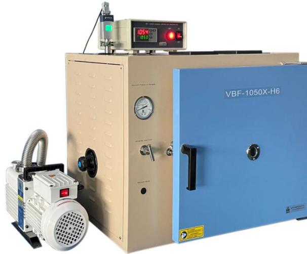
VBF-1050X-H6 是一款小型的真空箱式炉，炉膛采用高纯氧化铝纤维材料，最高温度能达到 1050 度，可连续工作温度 1000 度，控温精度  $\pm 1$  度。
